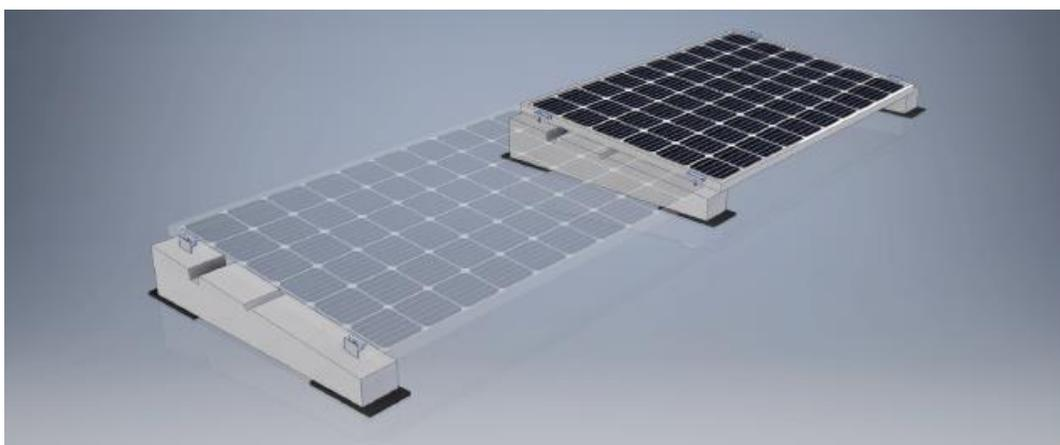
**Figura 4 - Esempio di posa dei moduli su zavorre di sostegno in calcestruzzo**
