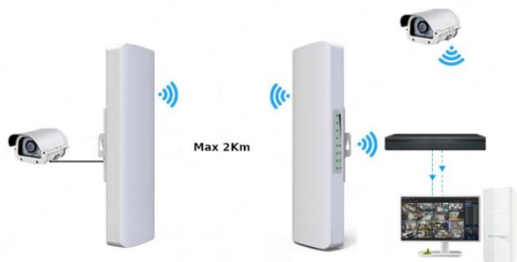
Figura 6 Schema trasmissione immagini telecamere
