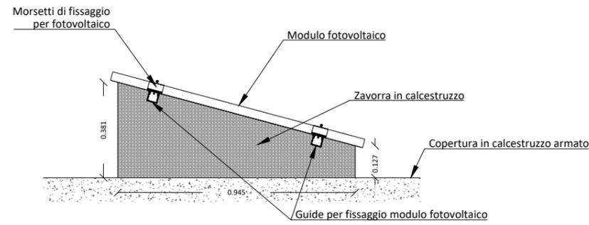
Particolare installazione moduli fotovoltaici su zavorre
