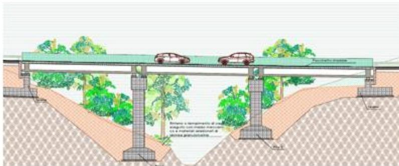
2. Viadotto Lombe, di 4 campate, della lunghezza pari a 61.32 m da giunto a giunto;
