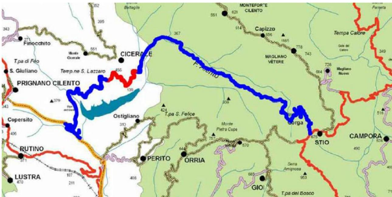
L'intervento consiste nel lotto di completamento di 2.746 metri oltre ai rammagli del progetto generale della strada provinciale SP 159/b zona diga Alento di 22,8 Km che collega la ex SP 430 alla SS 488, in Provincia di Salerno.
