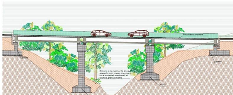
**Viadotto Lombe**, di 4 campate, della lunghezza pari a 61,32 m da giunto a giunto;
