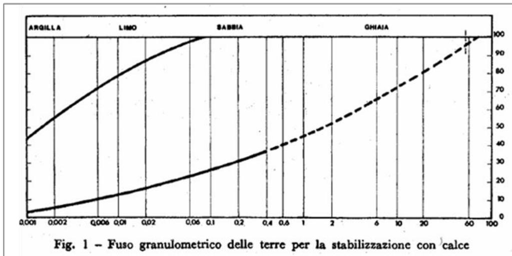
Fig. 1 - Fuso granulometrico delle terre per la stabilizzazione con calce
