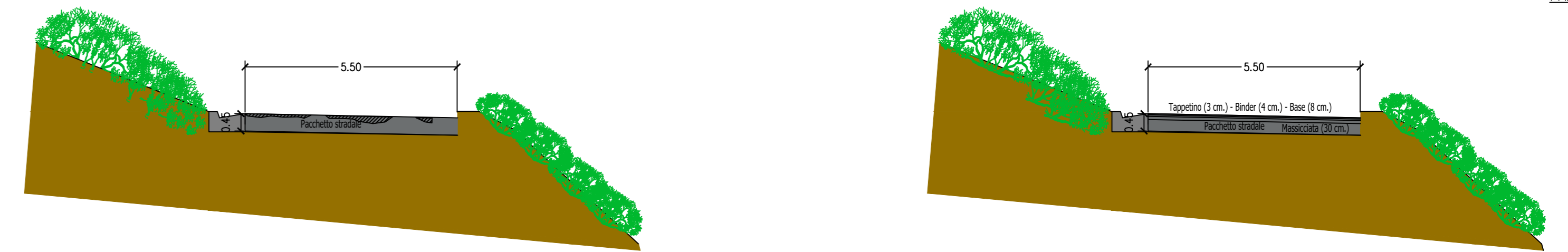
INTERVENTO 15 Problematica: tratti ammalorati lungo la rete stradale Intervento: ripristino manto stradale (massicciata - 30 cm., base - 8 cm., binder - 4 cm., tappetino di usura - 3 cm.) per 1 Km. - Tappetino (3 cm.) per l'intero tratto
