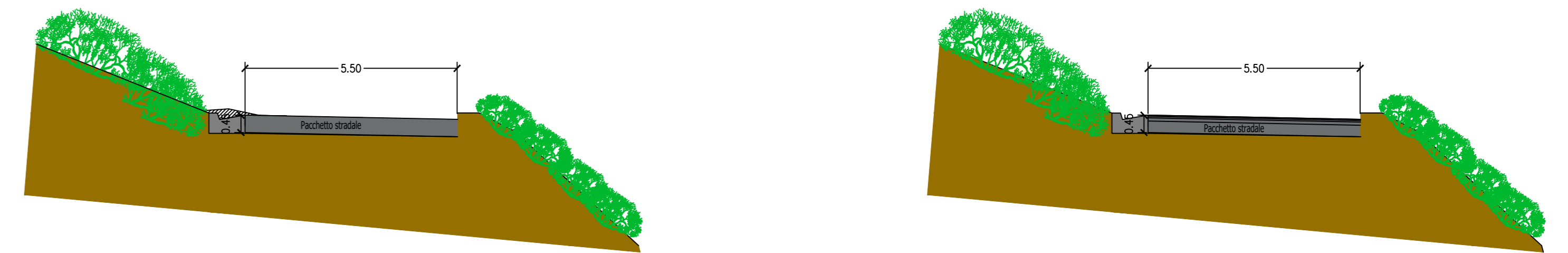
INTERVENTO 16 Problematica: interruzione funzionalità zanelle a causa della presenza di ostruzioni lungo lo sviluppo delle stesse Intervento: pulizia e ripristino officiosità delle zanelle
